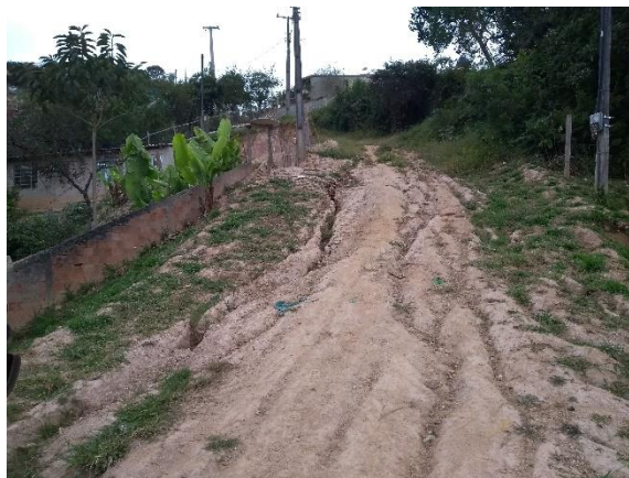
Figura 62: Ravinamento do solo por enxurradas.
